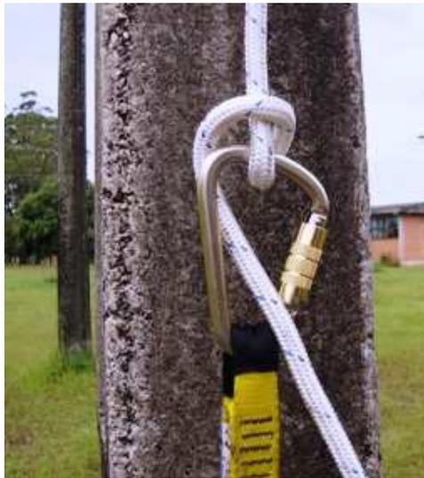
Figura 15 – Ajuste do nó de freio
